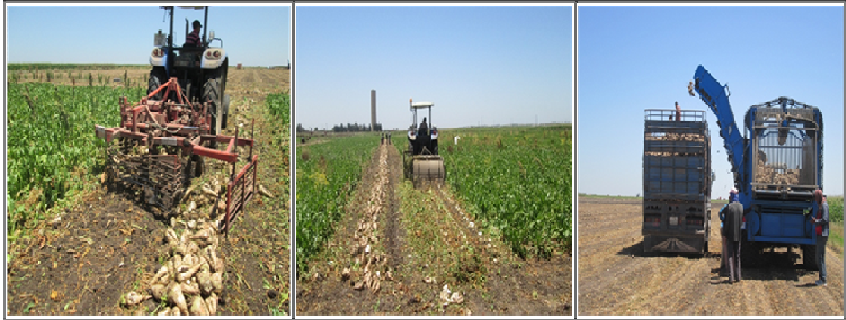
صورة 18: عملية جني الشمندر السكري (من اليسار إلى اليمين: قلع الشمندر السكري - وضع جنور الشمندر السكري على شكل خطوط - شحن الشمندر السكري) المصدر: المساعدة التقنية، صفقة رقم 26/2012/DK-DDA
