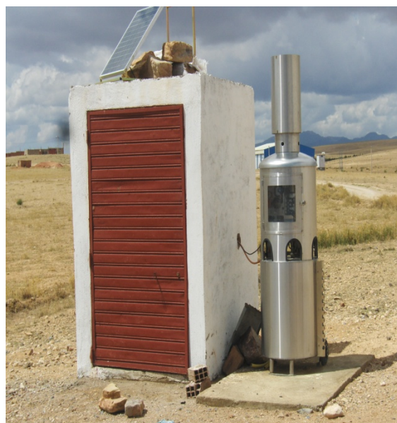
Photo 37: générateur anti-grêle (CR Zaïda)
